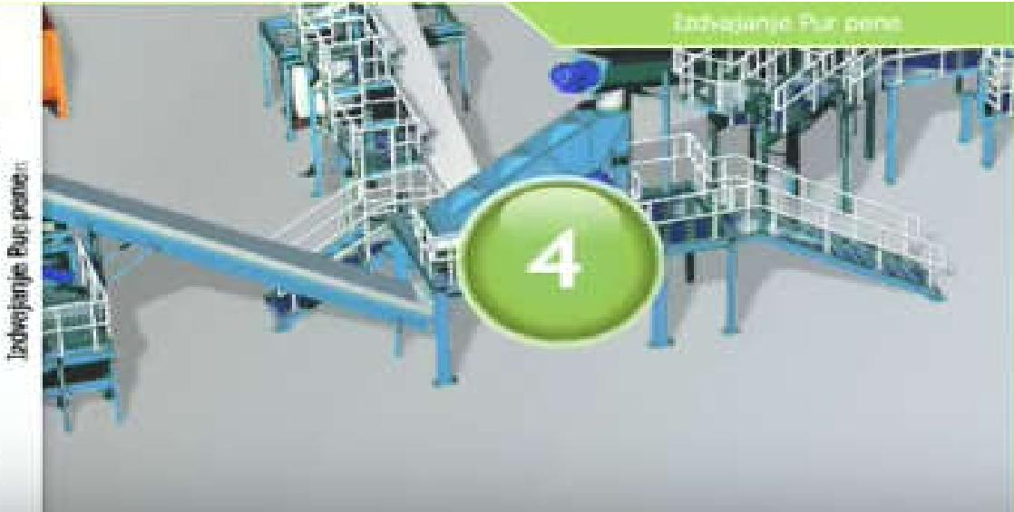
Pur pena se dalje transportuje pomoću specijalnih „matriksa“ koji se nalaze na visokoj temperaturi (120 stepeni C). Cilj visoke temperature je savršeno izdvajanje svih freona iz pur praha.
